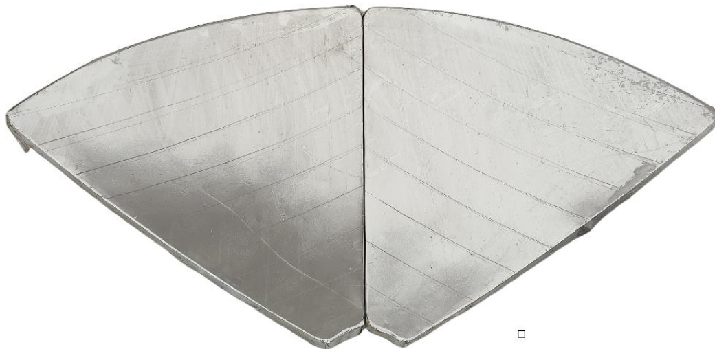
Рисунок 23 – Натурная модель сегментов параболического концентратора
